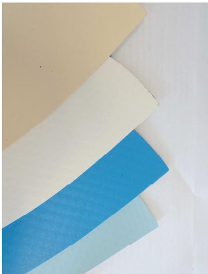
Membrana in PVC realizzata mediante calandratura con maglia interna di rinforzo in rete, adatta per questo motivo sia per un utilizzo pubblico che privato. E' il rivestimento ideale per piscine interrate di qualsiasi forma e misura.
