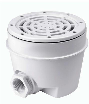
Preso di fondo in ABS con uscita laterale da 2" e riduzione da 2" a 1" ½ completo di attacco Ø 50 sul fondo, chiuso con diaframma a rottura prestabilita.
